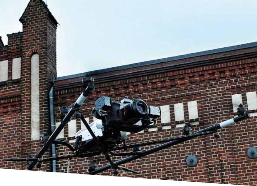
*Die Drohne ist nur das fliegende Stativ für die Kamera, z.B. die Sony Alpha 7 R. Vor dem Start der Drohne sollte die Mission so sorgfältig wie möglich durchgeplant werden.*
